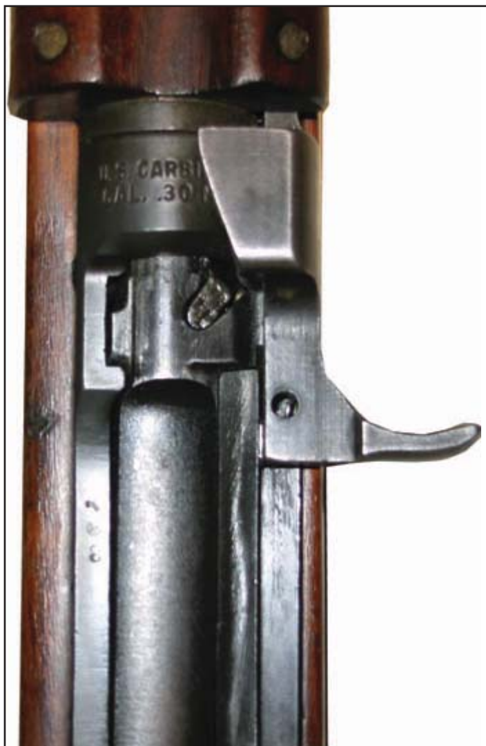
El percutor y la palanca de montar. Nótese los dos remaches de la banda de madera superior
